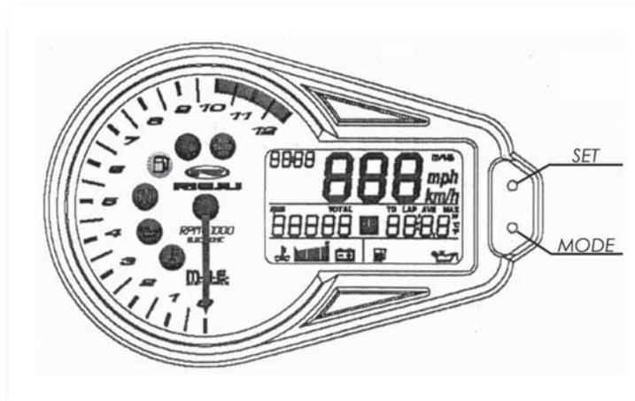
Le tableau de bord contient sur le coté droit, deux boutons, le bouton supérieur pour sélectionner "SET" et l'inférieur pour la fonction "MODE".
